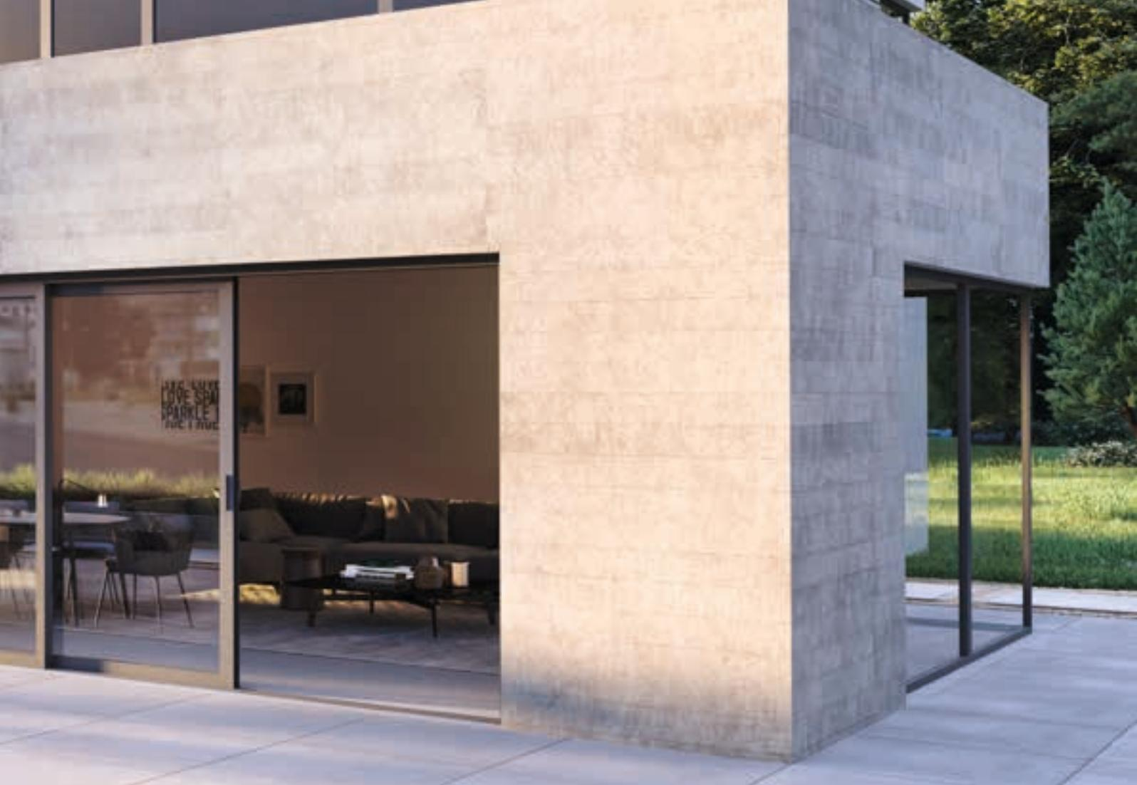
Grâce aux vues de profilé étroites du dormant de 57 mm seulement, 62 - 87 mm pour l'ouvrant et 62 mm pour la chicane centrale, le système de porte coulissante en aluminium heroyal S 65 affiche un design attractif. La chicane centrale réduite permet une transparence maximale du système, et en fait une solution idéale pour la construction résidentielle et commerciale haut de gamme.
